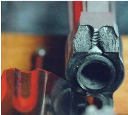
Typisches Abrissmuster der Rahmenbrücke. Nur das Putzen wird so erleichtert...
