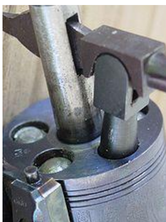
Abb.: Zum Laden der Trommelkammern musste beim Paterson der Lauf abgenommen werden und die Kugeln wurden mittels eines separaten Ladehebels in die Kammern eingepresst.
