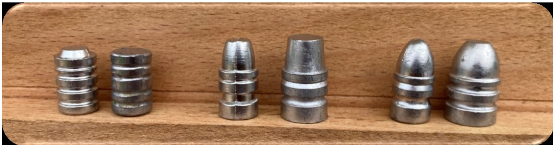
Abb Geschosse von li. nach re.: 2mal WC .357/.38, 1mal SWC .357/.38, 1mal SWC .44, 1mal RN .357/.38, 1mal RN .45
